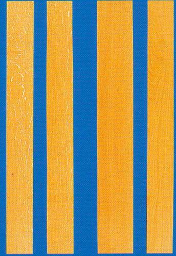
**S**chnittholz ohne Besonderheiten, Einschnittmerkmale und Veränderungen, außer auf 20 % der Stücke, die auf einer Seite oder einer Schmalseite 1 gesunden verwachsenen Ast von max. 10 mm Durchmesser (oder einen vergleichbaren) pro lfdm. enthalten können. Bei Stücken kleiner als 1 m zählt das ganze Stück.
